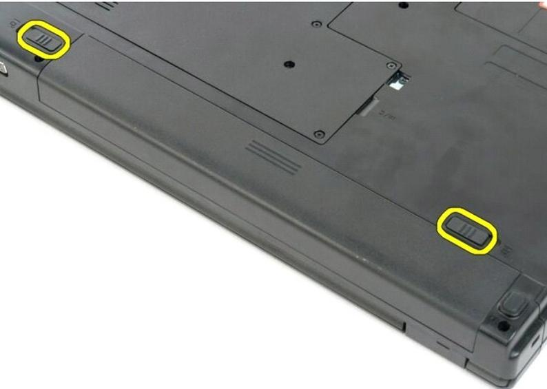
3. Deslice la batería hacia la parte posterior del ordenador para extraerla.
