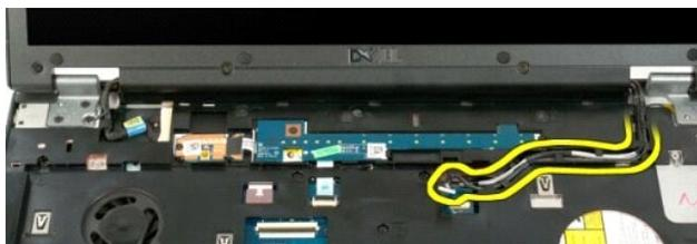
9. Desconecte el cable de datos de la pantalla de la placa base.
