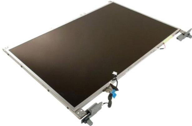
5. Quite los ocho tornillos que fijan las bisagras al ensamblaje del panel de la pantalla.
