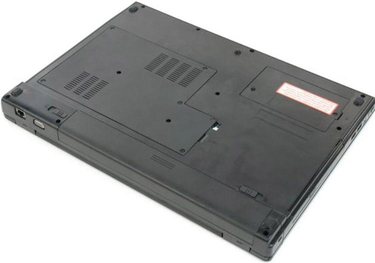
2. Deslice los pestillos de fijación de la batería hasta la posición de desbloqueo.
