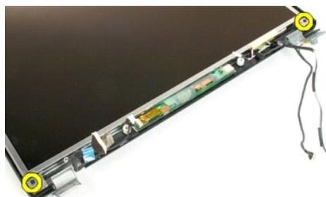
5. Extraiga el panel de la pantalla LCD del ensamblaje de la pantalla.
