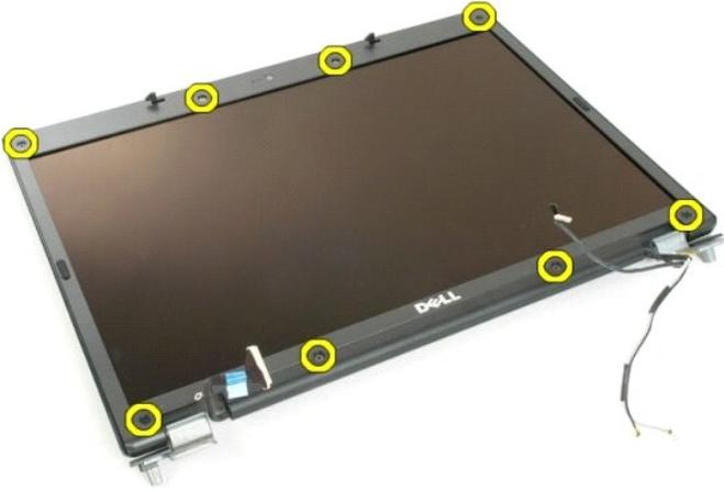
5. Extraiga el embellecedor del ensamblaje de la pantalla.
