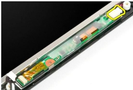
5. Extraiga el inversor del ensamblaje de la pantalla.
