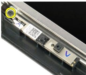
5. Levante la cámara del soporte de retención.
