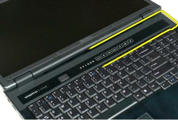
5. Continúe separando la cubierta de las bisagras del sistema de derecha a izquierda y, a continuación, extráigala.
