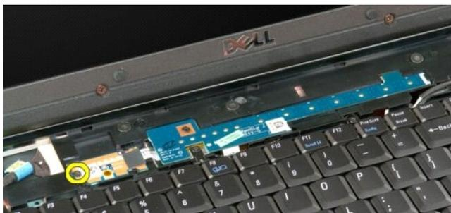
5. Deslice la placa del botón de encendido hacia la derecha.
