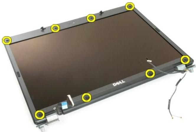
4. Quite los ocho tornillos que fijan el embellecedor al ensamblaje de la pantalla.
