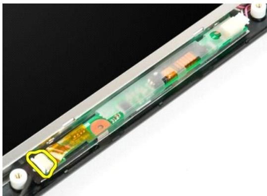
4. Desconecte el cable de alimentación del inversor de la pantalla.
