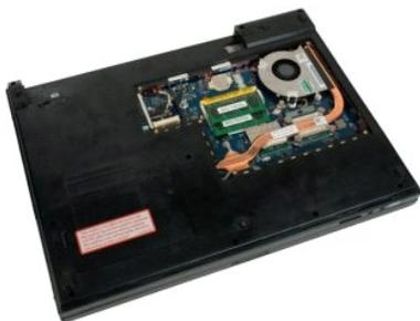
4. Desconecte el cable del ventilador de la placa base.
