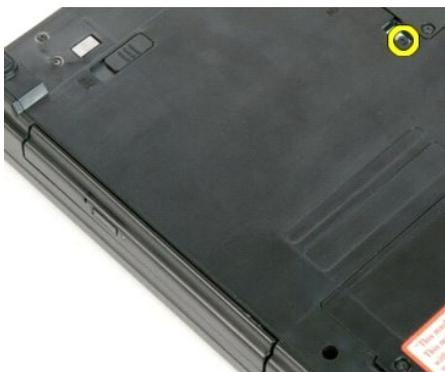
4. Inserte un instrumento de plástico acabado en punta en la muesca y deslice ligeramente la unidad óptica para extraerla del ordenador.
