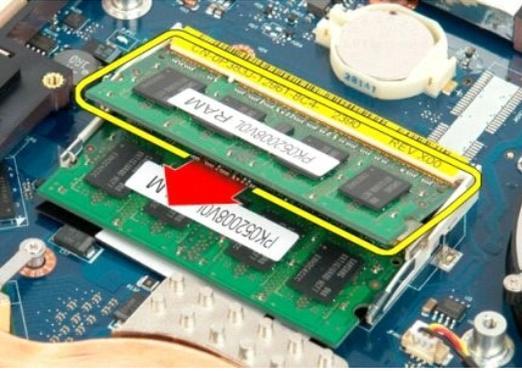
6. Si procede, extraiga el módulo de memoria inferior; para ello, abra cuidadosamente con la punta de los dedos los ganchos de fijación situados en cada extremo del conector para módulos de memoria hasta que el módulo de memoria se expulse.
