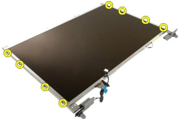
6. Separe las bisagras del ensamblaje del panel de la pantalla.
