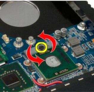
9. Levante el procesador para extraerlo del zócalo sin doblar ninguna de sus patas.
