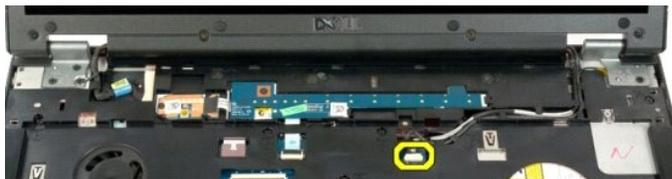
8. Retire los cables de datos y de antena del reposamanos.
