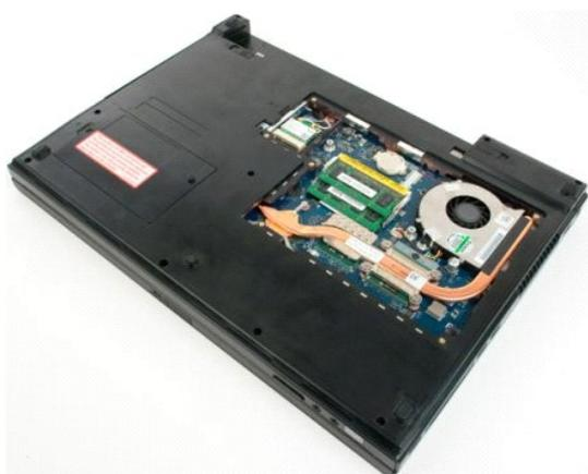
4. Si procede, extraiga el módulo de memoria superior; para ello, abra cuidadosamente con la punta de los dedos los ganchos de fijación situados en cada extremo del conector para módulos de memoria superior hasta que el módulo de memoria se expulse.
