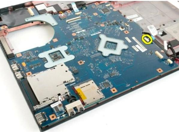
14. Desconecte el cable de alimentación de la placa base.
