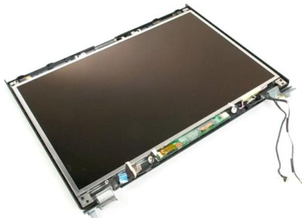
4. Quite los dos tornillos que fijan el panel de la pantalla LCD al ensamblaje de la pantalla.
