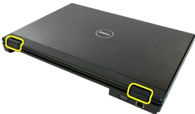
4. Separe la cubierta de las bisagras de la base del ordenador empezando por el lado derecho.
