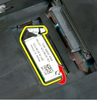
6. Desconecte el cable de datos del módulo Bluetooth.
