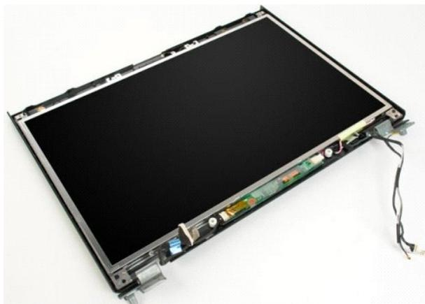
3. Desconecte el cable de datos del inversor de la pantalla.
