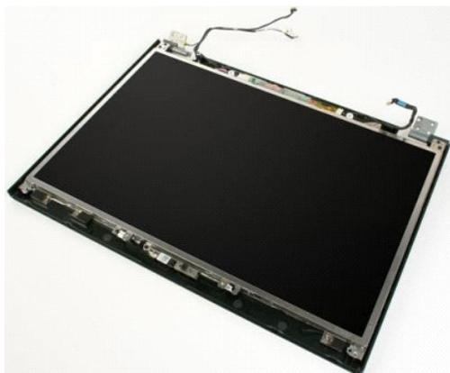
4. Quite el tornillo que fija la cámara al ensamblaje de la pantalla.
