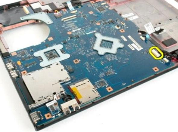
13. Desconecte el cable de datos de la placa base.
