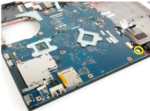
12. Desconecte el cable de datos de la placa base.
