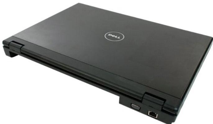
3. Utilice un instrumento de plástico acabado en punta para levantar con cuidado la parte posterior de la cubierta de las bisagras y separarla de la base del ordenador.
