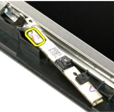
7. Extraiga la cámara del ensamblaje de la pantalla.
