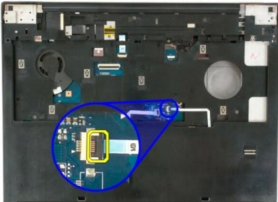
10. Retire el cable de datos del lector de huellas digitales del seguro para cable.
