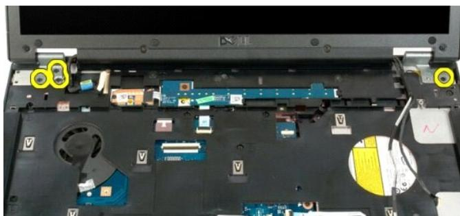
11. Levante el ensamblaje de la pantalla y extráigalo del ordenador.
